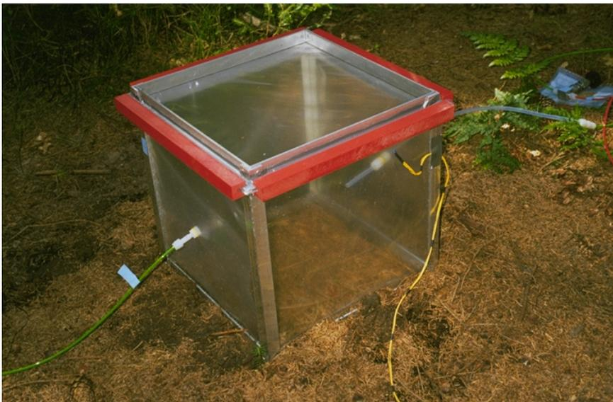
Abbildung 2.5: Foto der dynamischen Bodenkammer im Gelände.
