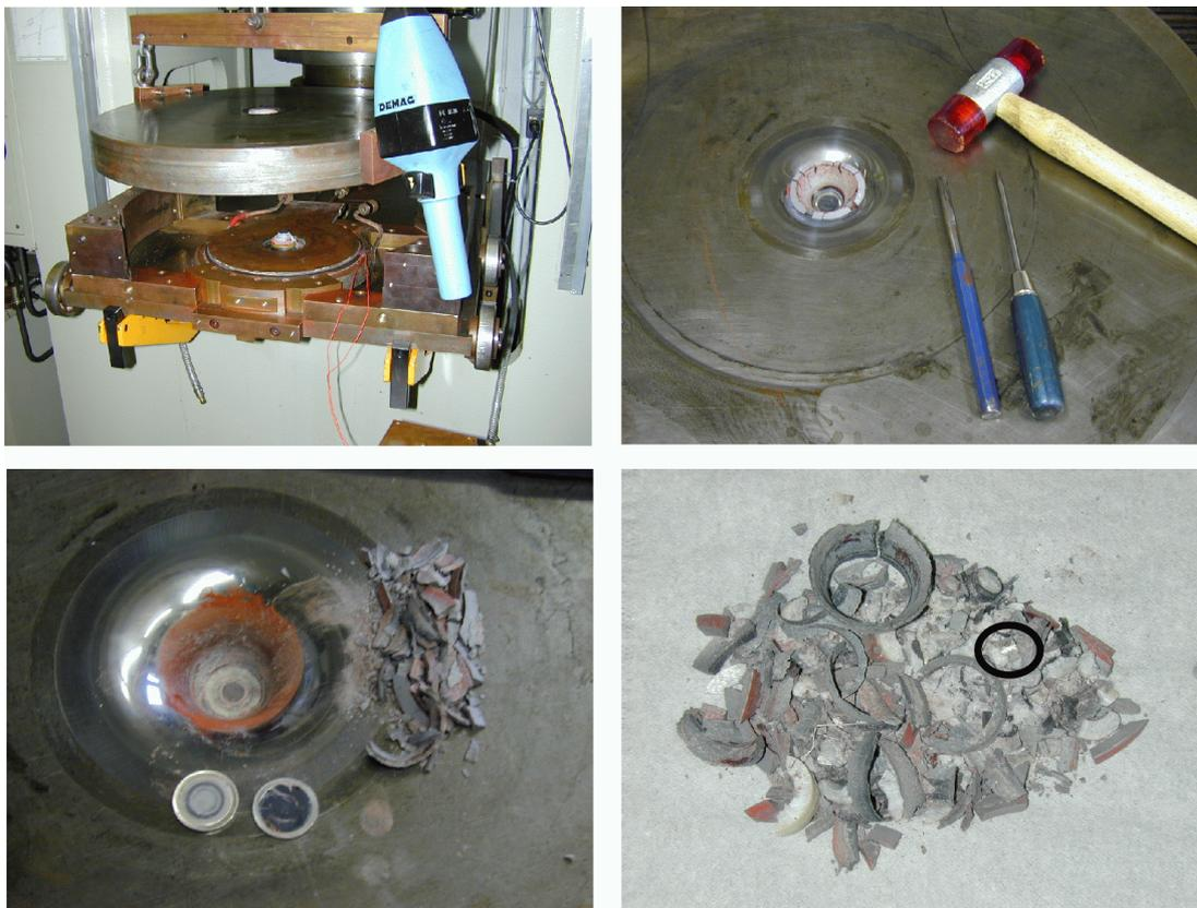
Abbildung 2.11: Fotografien zum Ausbau der Probe nach beendetem Hochdruckexperiment. Die Lage der Kapsel ist schwarz markiert. Zur Erläuterung siehe den Text.
