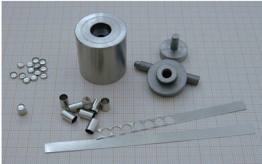
Abbildung 2.8: Deckelformer für den Deckel und den Boden der Platinkapsel (hinten), mit Deckeln (hinten links), Pt-Streifen (unten rechts) Pt-Röhrchen (vorne mitte) und einer fertigen Platinkapsel.
