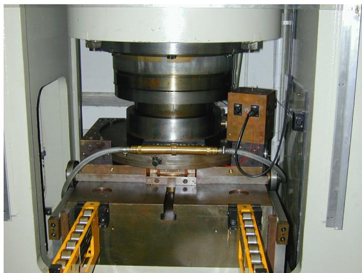
Abbildung 2.7: Fotografie der Belt Anlage. Man erkennt oben den Hydraulikzylinder, die PVC-Wasserzuführungen für die untere Kühlplatte, darunter das Belt-Element mit Haken zum anheben. Der Messingkasten rechts nimmt die Thermoelement-Zuführungen auf.
