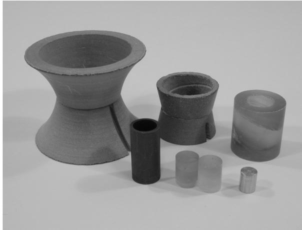
Abbildung 2.9: Inset für ein Hochdruckexperiment. Hinten links und mittig sind die Pyrophyllit-Dichtungen zu sehen, rechts der äußere Fluoridzylinder, davor eine Platinkapsel. Vorne in der Mitte stehen die kleinen Fluoridzylinder, links daneben der Graphitheizer.
