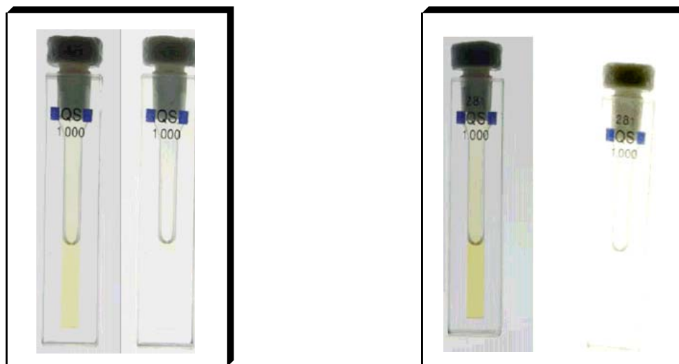
Abbildung 53: Oxidierte und reduzierte (farblose) Form der Phenazine. Das linke Schaubild zeigt die Phenazin-Stammverbindung (1H-Pyrazolo[3,4-b]chinoxalin-3-ylamin) 112 . Das rechte Schaubild zeigt die Pyrazolring-N-methylierte Spezies 98 (1-Methyl-1H-pyrazolo[3,4-b]chinoxalin-3-amine) jeweils in der oxidierten (links) und der reduzierten (rechts, farblose Küvette) Form
