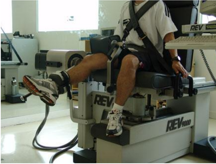
Joonis 1. Isokineetilise jõu määramine dünamomeetriga REV9000 (TechnoGym, Italy).
