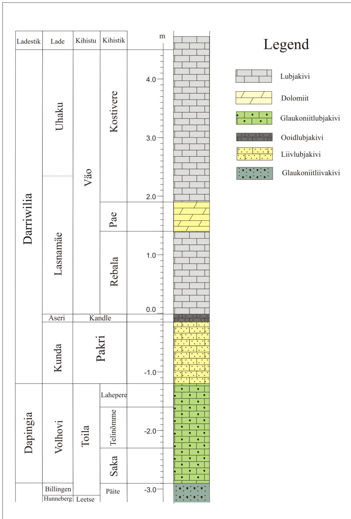
Joonis 4. Uuga paljandi litoloogiline tulp (Tammekänd et al. , 2009; Hints et al. , 2012 alusel).
