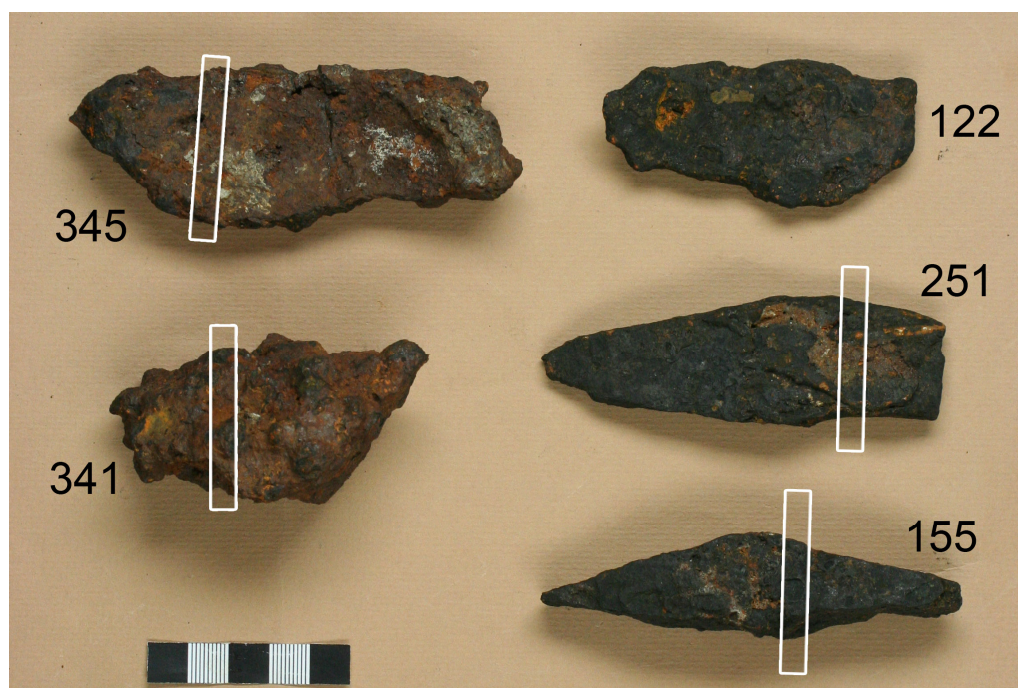
Foto 8. Rauakangid ja toorraud Käku sepikojaasemelt. Eraldi on märgitud metallograafilise analüüsi tarbeks tehtud lõigete asukohad.
