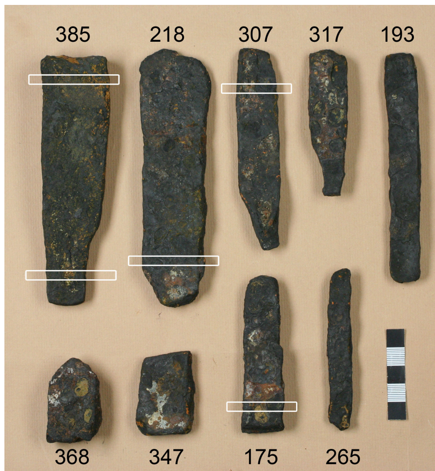
Foto 7. Rauakangid Käku sepikojaasemelt. Valged kastid märgivad metallograafilise analüüsi tarbeks tehtud lõikeid.
