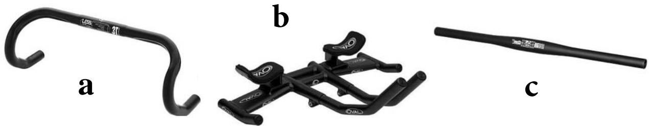
Joonis 7. Erinevatel jalgrattaspordi alade võistlusratastel kasutatavad põhilised juhtraua tüübid: a – ühisstardi, b – eraldistardi ja c – maastikusõidu rataste juhtrauad.
