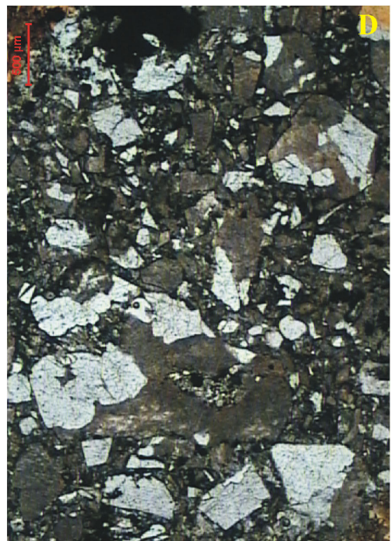
Joonis 28. Mikrofotod (pildistanud U. Preeden): a) kvarts allohtoonse bretša maatriksis (Av-1), b) plagioklass allohtoonse bretša maatriksis (ristniikolites) (õhik Av-2), c) granofüürilise struktuuriga kvarts (ristniikolites) (õhik LM-E-4), d) par-autohtoonse bretša maatriks (õhik LM-17A).
