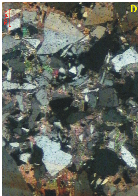
Joonis 22. Mikrofotod (pildistanud U. Preeden): a) peenpurd materjal allohtoonse bretša maatriksis (õhik K18 3830), b) PDF kvarts allohtoonse bretša maatriksis (foto pikim külj 1.1 mm) (õhik K18 3830) (pildistanud V. Puura), c) killuline kvarts par-autohtoonse bretša maatriksis (NGR-5), d) sama, mis eelmine ristniikolites.
