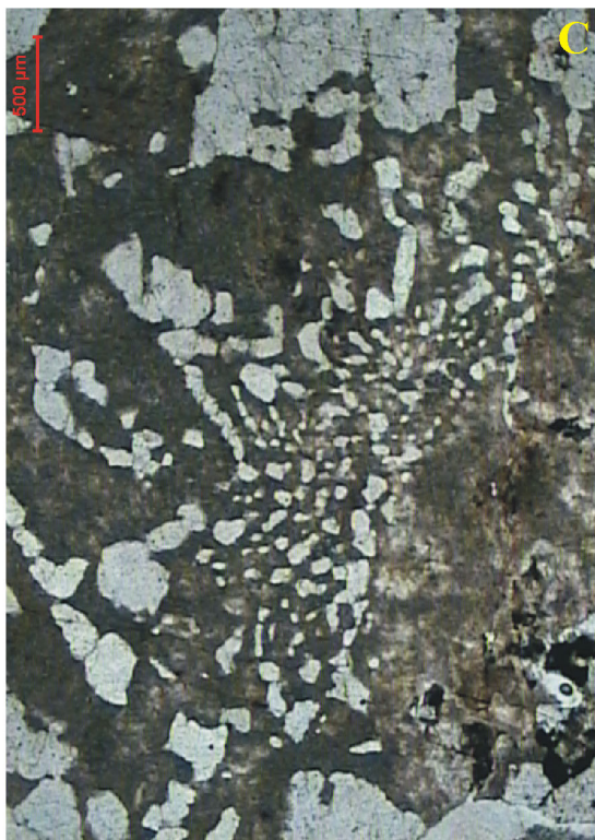
Joonis 28. Mikrofotod (pildistanud U. Preeden): a) kvarts allohtoonse bretša maatriksis (Av-1), b) plagioklass allohtoonse bretša maatriksis (ristniikolites) (õhik Av-2), c) granofüürilise struktuuriga kvarts (ristniikolites) (õhik LM-E-4), d) par-autohtoonse bretša maatriks (õhik LM-17A).
