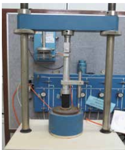
Slika 3. Ispitivanja jednoosne tlačne čvrstoće opterećenjem od 5kN
