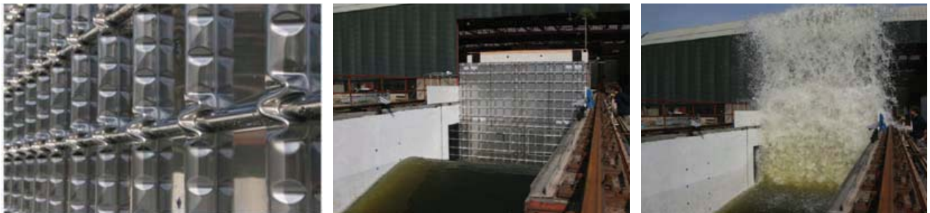
Figure 6 Quasi full scale impact experiments (Sloskel project) Slika 6 Mjerenja kvazi naravnih udara (projekt Sloskel)
