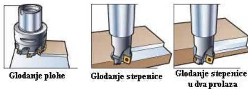
Slika 12. Geometrijski pogodni alati za obradu
