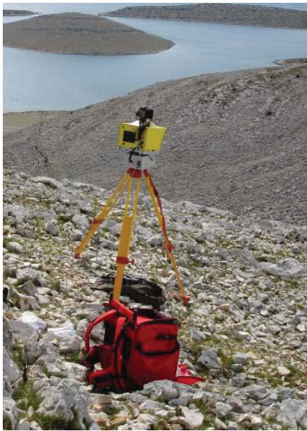
Slika 1. Optech ILRIS postavljen na lokaciji
