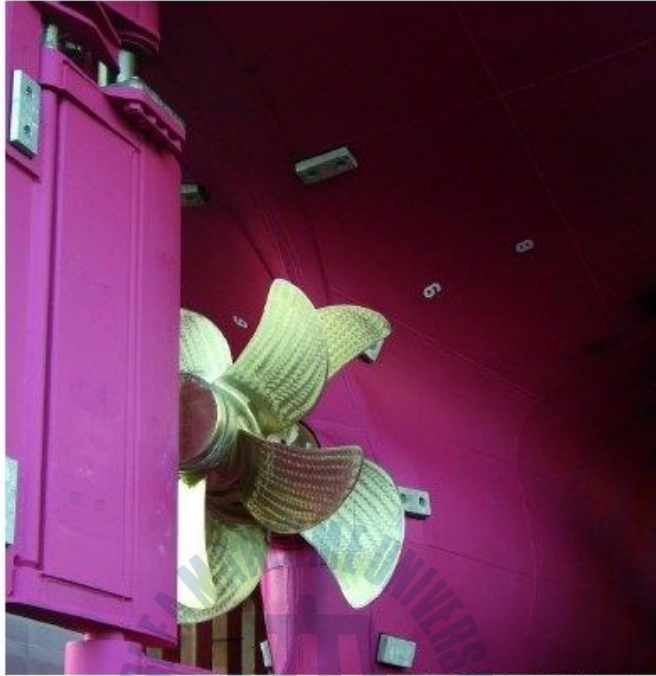
Fig. 3.1 Contra Rotating Propeller(CRP)
