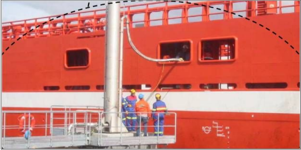
Fig. 5.12 탱크로리에 의한 LNG 병커링(2)
