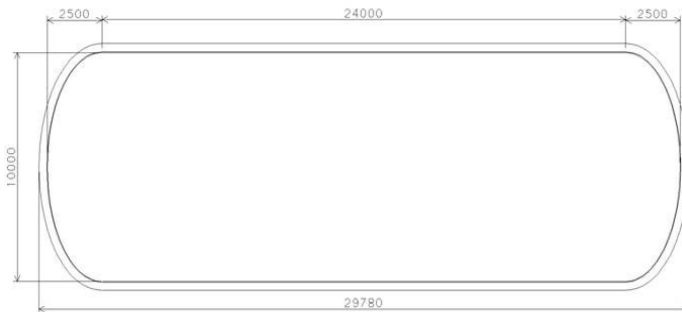
Fig. 5.5 IMO Type-C 연료탱크 형상
