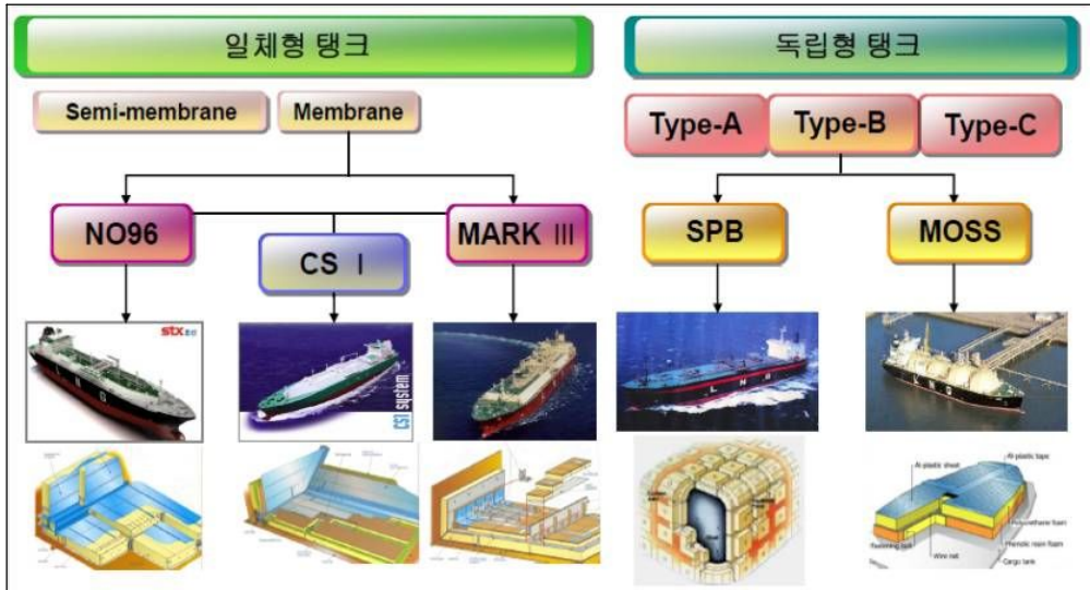
Fig. 5.1 IGC Code에 의한 LNG 탱크 구분
