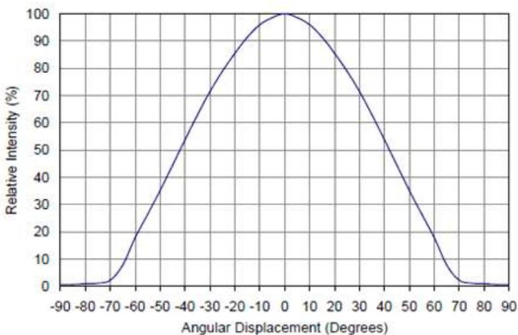
Fig. 9 Divergence angle of LED<sup>[24]</sup>
