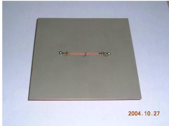
그림 3.6 1-Capacitor를 이용한 LPF
