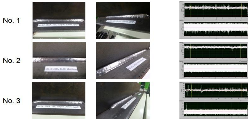
Fig. 3.11 Gap=0일 때, 적정 용접 데이터 3(전류-전압신호 및 비드형상)
