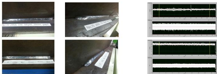
Fig. 3.16 Gap=2일 때, 적정 용접 데이터 1(전류-전압신호 및 비드형상)
