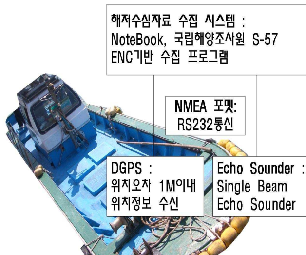
<그림 12> 해저수심자료 수집 시스템 구성도
