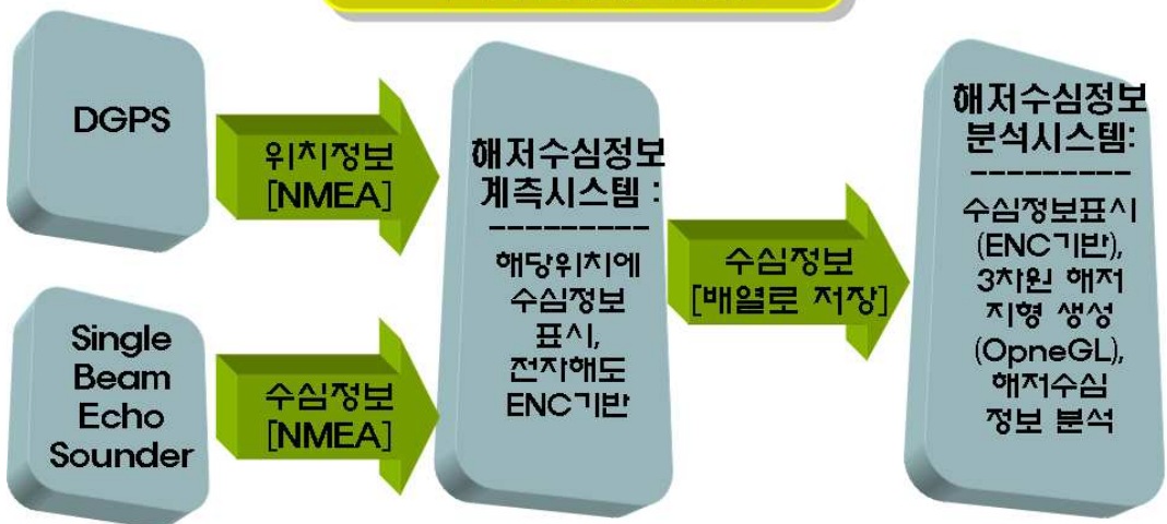
<그림 21> S/W 시스템 데이터 흐름도
