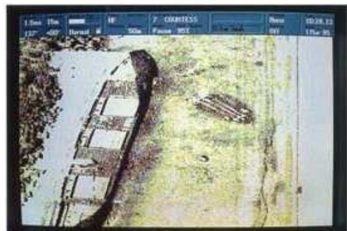
<그림 6> 미국 Odom사의 CM800 시스템(사이드 스캔 소나)과 영상화된 해저의 선박
