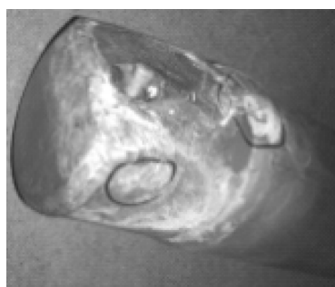
Slika 4. Oštećeno kućište kamere
