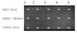
Figure 11. Measuring points in the machined sample surface Slika 11. Merna mesta po obrađenoj površini uzorka
