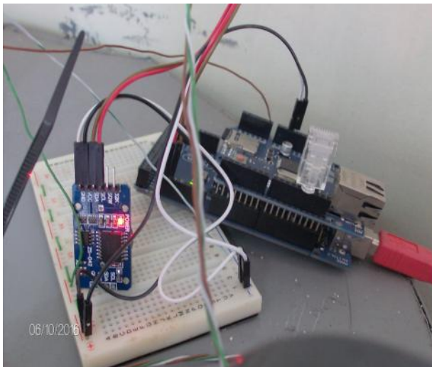
Circuito de control utilizando tecnología ARDUINO
