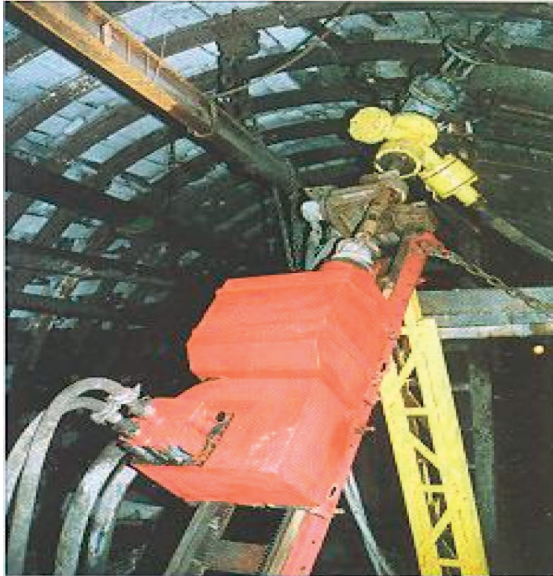
Figure 5 Drilling of degasification boreholes with preventers Slika 5. Bušenje otplinjavajuće bušotine sa protuerupcijskim uređajima
