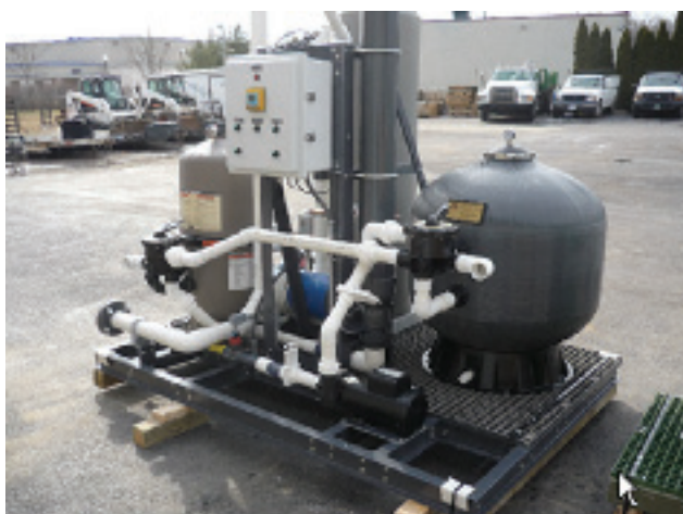
Slika 2. Dio komponenata sustava za depuraciju (mehanički filtri: dijatomejski i pješčani, te UV sterilizator).
