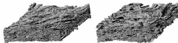
Figure 3 Two different examples of three-dimensional paper structure obtained by X-rays 65 tomography [15] Slika 3. Prikaz trodimenzionalne strukture papira od dva različita uzorka dobivena pomoću X-zraka 65 tomografije [15]
