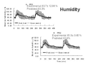
Figure 17. Comparison between simulated and measured RH distributions in PPC1 and PPC2 Slika 17. Usporedba između simuliranih i izmjerenih distribucija relativnih vlažnosti OOZ1 i OOZ2
