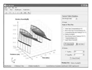
Figure 14. Relative humidity distribution at the first layer of garment in PPC1 Slika 14. Distribucija relativne vlažnosti prvog sloja odjevnog predmeta u OOZ1
