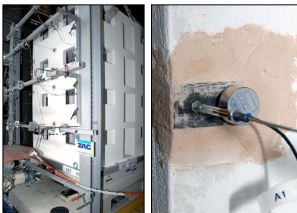
Slika 11. a) Okvir za pričvršćivanje mjeraca pomaka i detalj pričvršćivanja mjeraca pomaka i b) akcelerometra na model
