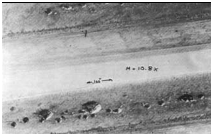
Slika 3. Jamičenje na bokovima zuba [13] Figure 3. Pitting on gears teeth flanks [13]
