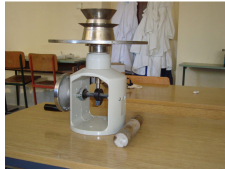
Slika 3 - Potresni stolić za određivanje konzistencije mortova
