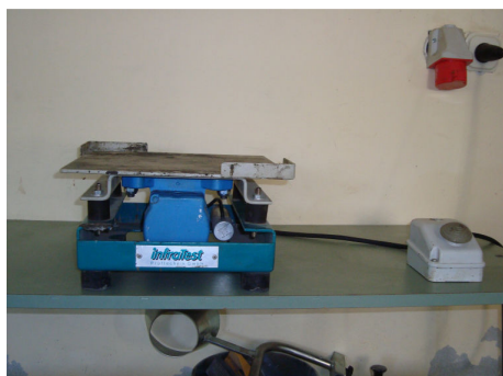
Slika 4 – Vibrostol za zbijanje svježeg morta
