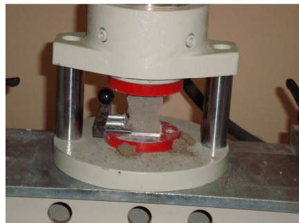
Slika 8 - Ispitivanje tlačne čvrstoće morta
