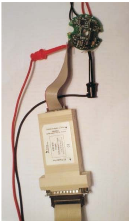
Figure 8 Communication with the target prototype using JTAG tool Slika 8. Komuniciranje s ciljnim prototipom pomoću JTAG alata
