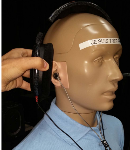
Figure 4.3 Montage du mannequin, du casque d'écoute et des microphones binauraux pour la validation de la reproduction d'échantillons utilisés lors de tests d'écoute.
