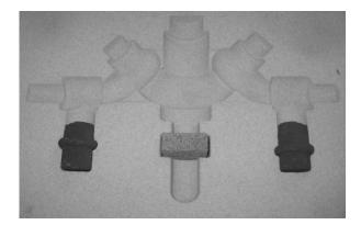
Figure 9. Inserting mould cores and filter. Slika 9. Plasiranje jedra i filtera u lijevarsku formu
