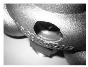
**Figure 14.** Thin upper wall caused by vertical core movement **Slika 14.** Vrlo tanak gornji zid ventila kao uzrok vertikalnog guranja jedra u procesu lijevanja
