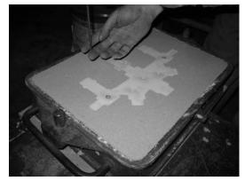
**Figure 6.** Curing of the sand form with CO2 gas **Slika 6.** Konsolidacija pijeska vrši se sa plinom CO2
