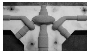
**Figure 17.** Polyamide mould for core manufacturing. A wire was added prior to  $CO_2$  curing in order to reinforce the core **Slika 17.** Model za proizvodnju jedara iz poliamida. U jedru se stavilo dodatnu armaturu u oblici čelične žice i nakon toga utvrđivalo sa CO2 plinom, kako bi jedro moglo, da se zoperstavi silama kod lijevanja
