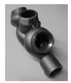
**Figure 11.** Casting after final machining **Slika 11.** Ventil nakon finalnog strojnog tretmana na CNC postrojenju
