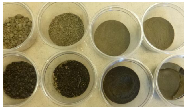
Tørr jord øverst og fuktet jord nederst. Fra venstre mot høyre jordaggregater og mineralkorn over grovsandstørrelse (2-4 mm), grov og mellomsand (0,25- 2 mm) og finsand (0,06- 0,25mm). Helt til høyre er silt og leir samlet (<0,06 mm). Leirpartiklene (< 2 µm) er for små til å kunne siktes fra. Foto: Reidun Pommeresche, NORSØK.
