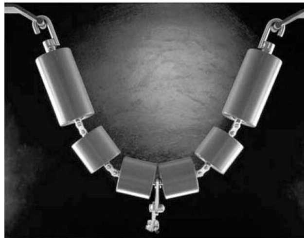
Figure 7 Deep semi-circular trough roller configuration [5] Slika 7. Raspored valjaka dubokog polukružnog valjčanog sloga [5]
