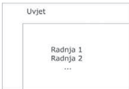
Slika 5. Simbol za while petlju u struktogramu Figure 5. The while loop symbol
