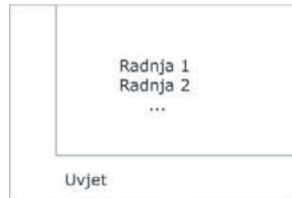
Slika 7. Simbol za do-while petlju u struktogramu Figure 7. The do-while loop symbol
