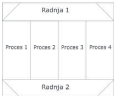
Slika 9. Simbol paralelnih procesa u struktogramu Figure 9. The parallel processing symbol
