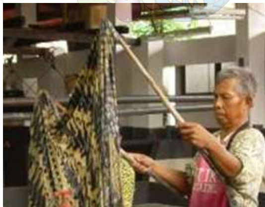
Gbr. 7. Ngebyok/Nglorod : Menghilangkan semua malam yang menempel dalam air mendidih.
