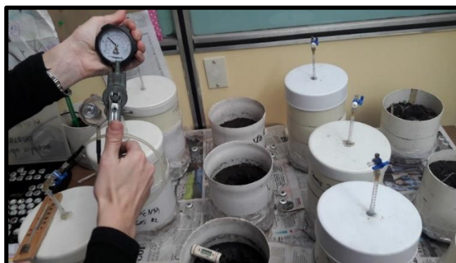
Figura 6. 3: Fotografía de la extracción de gas con la bomba de vacío a partir de los cilindro (utilizado como base al momento de muestreo de gases) con suelo de cada tratamiento y la cámaras colectoras de gases.
