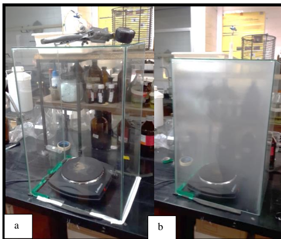
Figura 6. 6 a y b: Fotografías de la cámara de vidrio, en su interior se puede notar el quemador eléctrico y en su exterior la salida con la bomba para la toma de gases (a) y (b) muestra el proceso de combustión.
