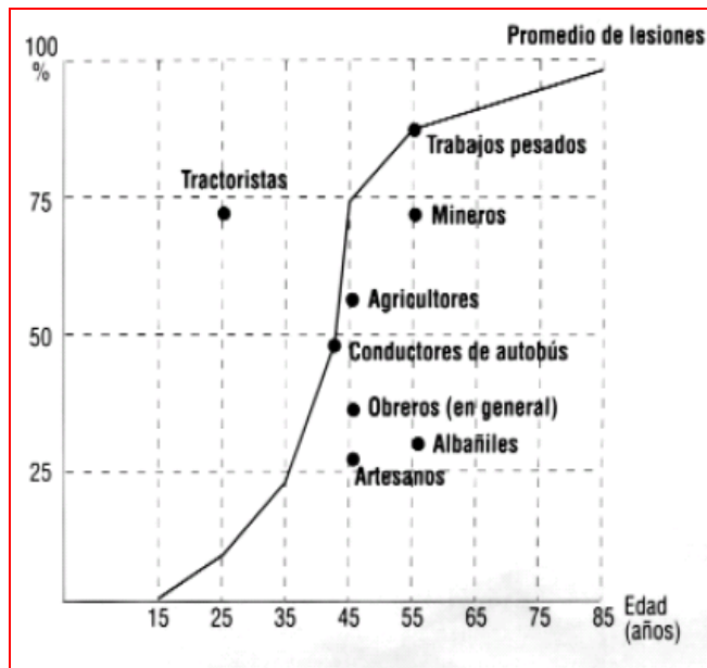
Figura 4: Frecuencia de lesiones en la columna vertebral según el tipo de trabajo. Fuente: Márquez L. (2001)
