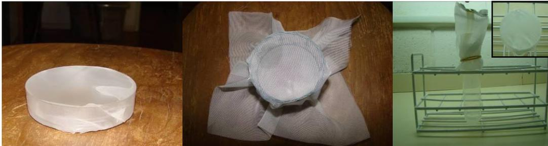
**Figura 3.1. Dispositivos empleados para exponer los áfidos a ozono sobre dieta artificial.** La imagen de la izquierda muestra la placa de petri con el sachet de dieta artificial formado por las dos láminas de Parafilm. La imagen del centro muestra el dispositivo armado con la malla plástica y la cubierta de voile sobre la placa de petri y la imagen de la derecha muestra el sachet montado sobre la boca de un tubo de centrífuga y la cubierta de voile.
