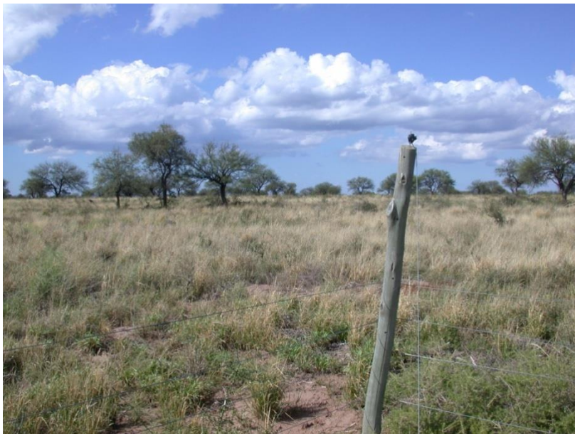
Figura 3. Alambrado de una parcela. Sobre el poste se ve el sensor que registra energía incidente.
