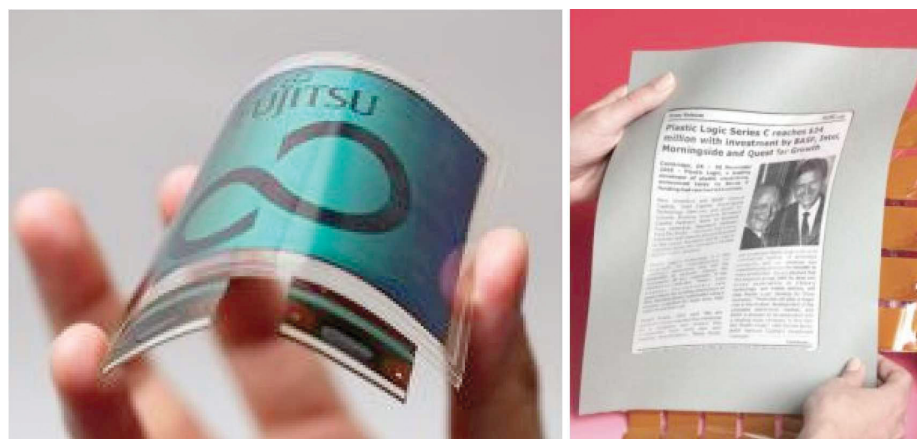
Slika 6. Elektronski papir imati će neka svojstva klasičnog papira (npr. savitljivost), a na njemu će se moći izmjenjivati slike (URL-6)
