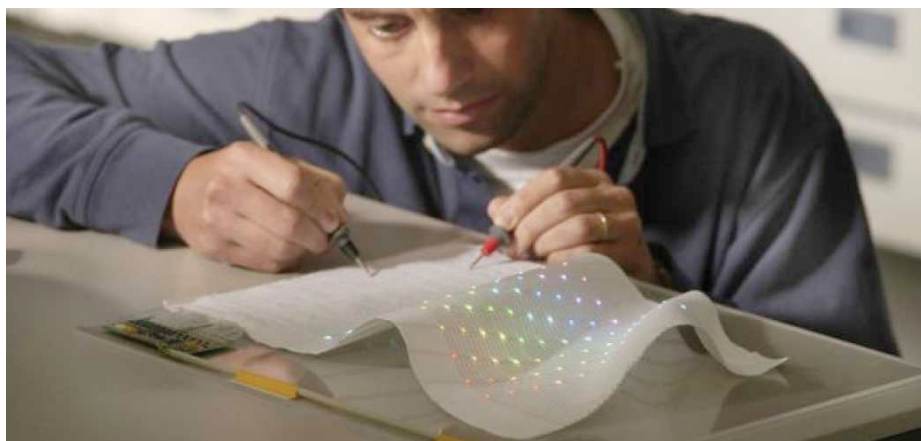
Slika 7. Osjetljivost elektronskog papira na električne impulse može se iskoristiti za prikaz modela terena (URL-7)
