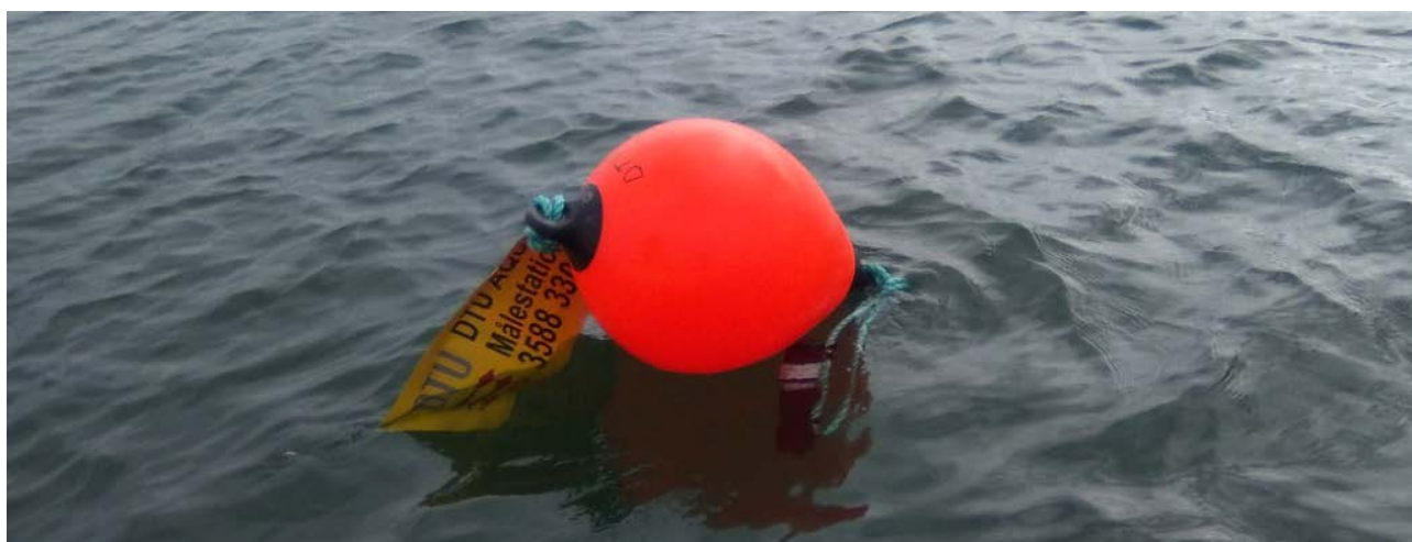
Figur 2. Bøje med ophængt hydrofon. Der var udfordringer med at disse bøjer forsvandt i løbet af studiet.
