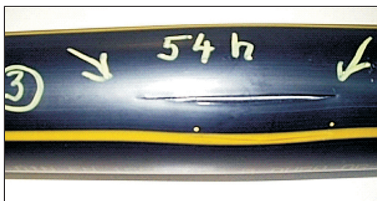
Figure 5 Pipe bursting at initial notch Slika 5. Puknuće cijevi na zareznom oštećenju
