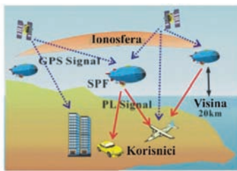
b) Navigacijsko-pozicijski servis; koristi pseudolite na stratosferskim platformama
