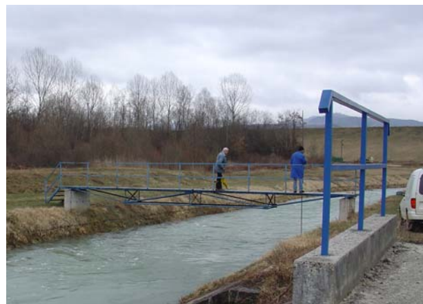
Slika 3. Mjerenje hidrometrijskim krilom na profilu 60B
