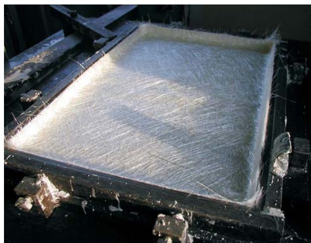
Slika 5 Predpripremljeno stakleno vlakno Figure 5 Pre-treatment of glass fibre
