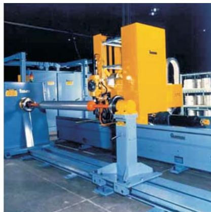
Slika 4 Postupak mokrog namotavanja [7] Figure 4 Wet winding [7]
