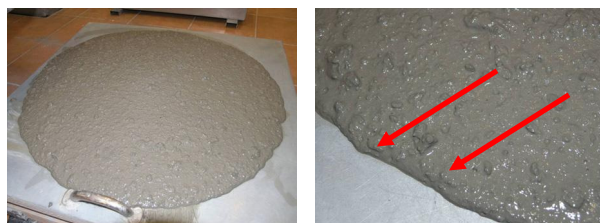
Slika 4. Prikaz rasprostiranja samozbijajućeg betona (lijevo) i izgled krajeva uzorka prilikom ispitivanja rasprostiranja (desno)
