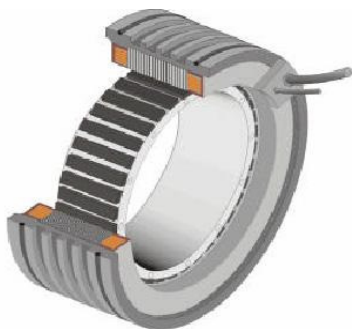
Slika 4. Visokomomentni motor u „kit“ izvedbi mehanizam dizala s kočnicom
