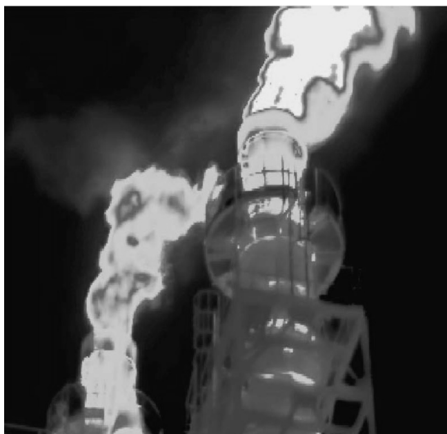
Slika 2 – Dva različita termograma snimljena termografskom kamerom FLIR SC2000 uz temperaturu okoline od 17,5 do 18,8 °C i brzinu vjetra od 0,8 do 2,5 m s -1
