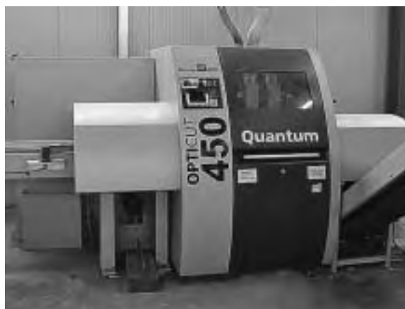
Slika 8. Detalj računalom upravljane kružne pile za poprečno piljenje drvnih elemenata optimiranjem duljina (PM Lignum)
