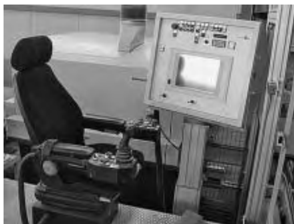
Slika 7. Detalj upravljačkoga radnog mjesta s računalnim sustavom za optimiranje položaja raspiljka na višelisnoj kružnoj pili (PM Lignum)
