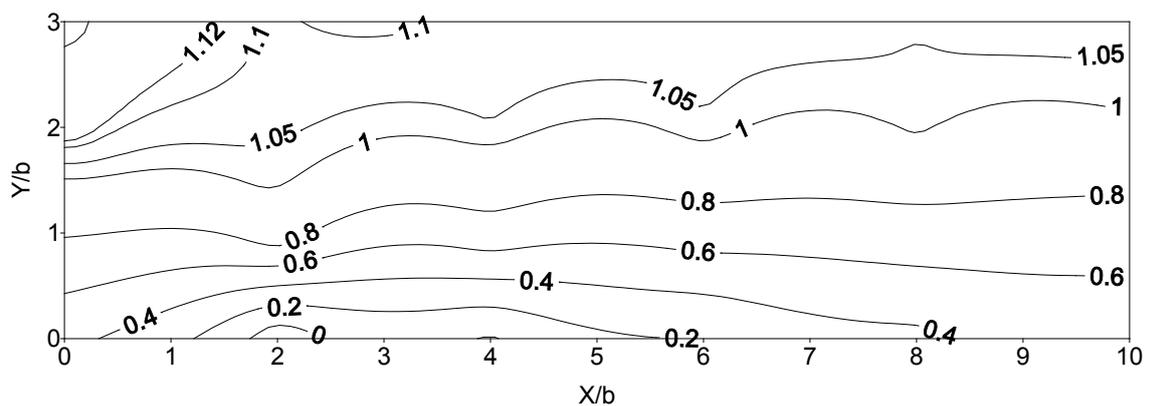
**Fig. 5 (d) Contour of interference factor for  $H_r=1.25$**
