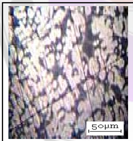
Gambar 3.3 Struktur Mikro Paduan Al A356 Setelah dikenakan Pengerjaan Dingin 40% Menggunakan Las Asetelin Dengan Waktu 20 Detik Ketebalan 4 mm Dengan Pembesaran 200X
